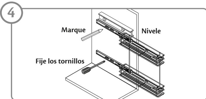
Abra los Rieles en su totalidad y ubique la Aceitera en el módulo a instalar, use el nivel para alinear y marque los puntos a perforar e instale con Tornillos de ensamble.
