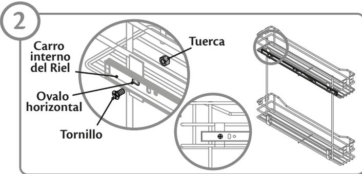
Ensamble el Carro interno del riel en la canasta superior de la Aceitera, con los Tornillos y las Tuercas.
