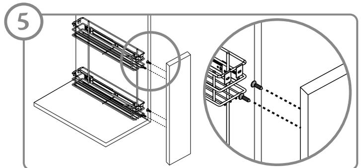
Para instalar la tapa parche, utilice las platinas frontales de la Aceitera como guía para marcar los puntos a perforar y fije con Tornillos de ensamble.
