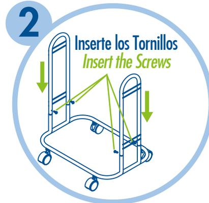
**2** Fije los Marcos en la Base y asegure con Tornillos. (Inserte los Tornillos a través de las perforaciones de los Marcos).
