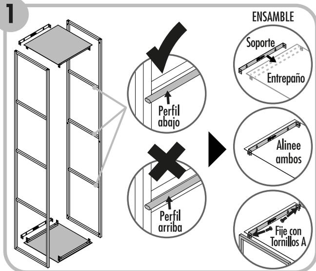
Ubique los Laterales con los Perfiles abajo y hacia el interior de la estructura. En cada extremo de los Laterales, fije con Tornillos A el ensamble de una Base y un Soporte, según gráfico.
